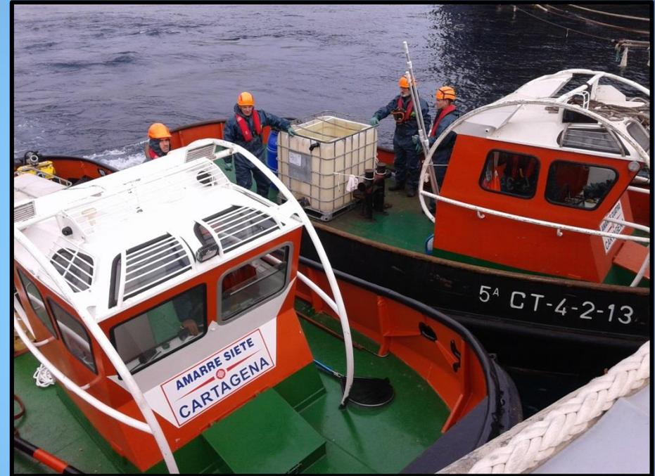
Continua la actividad en la zona logística, entran en acción los remolcadores para la lucha C.I y control del vertido. Dos embarcaciones de amarradores dotadas de skimmers, barrera corta, tangón y depósito de almacenamiento, se disponen a recoger los restos de biomasa flotante afectada por el vertido.
